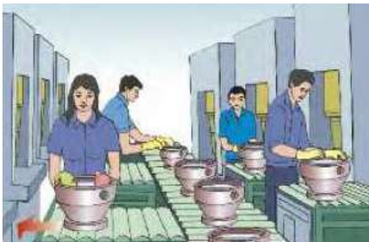
شکل ۳۶- نوار نقاله پاسیو جهت حرکت دادن موتورهای سنگین در ارتفاع کار
