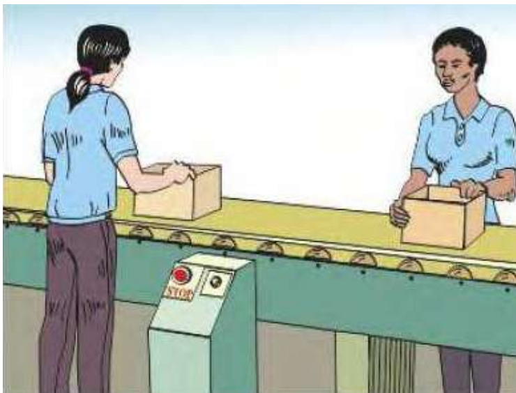
شکل ۳۷- طراحی پست کار با استفاده از نوار نقاله جهت کاهش حمل دستی مواد
