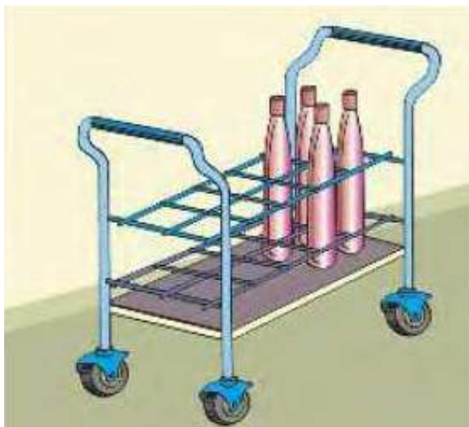
شکل ۴۴- گاری چرخدار قفسه ای جهت نگهداری و جابجایی سیلندر و کپسول های مخصوص
