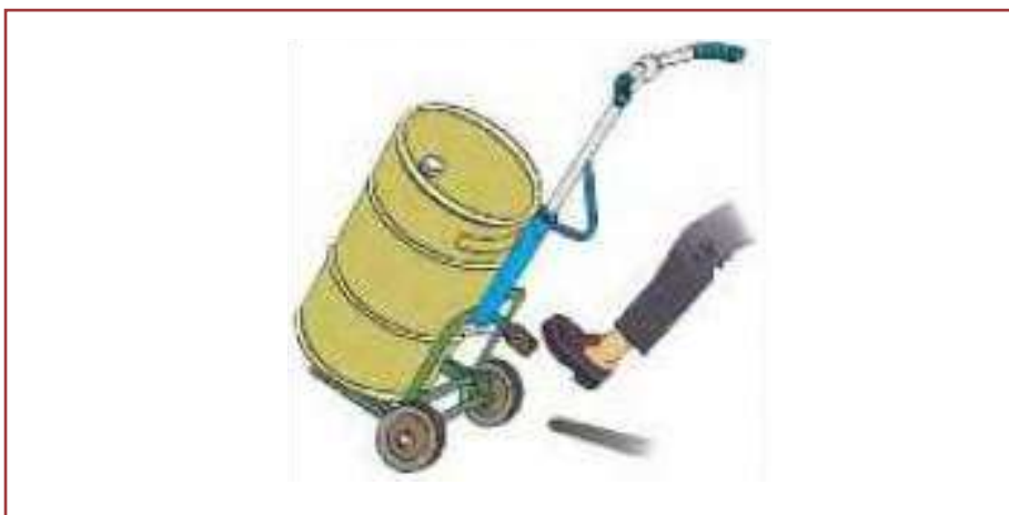
شکل ۳۴- گاری مخصوص حمل بشکه به منظور سهولت در حمل بار و جلوگیری از ایجاد آسیب به کارگر
